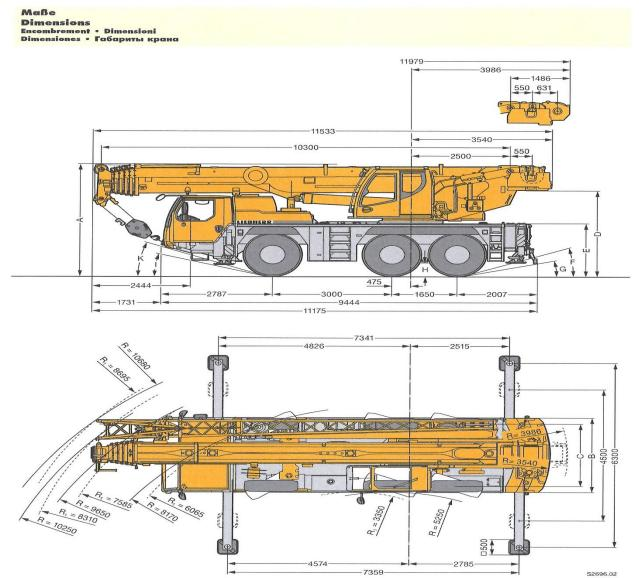
R, = Allradlenkung · All-wheel steering · Direction toutes roues · Tutti gli assi sterzanti · Dirección en todos los ејез · Поворот всеми колесами
